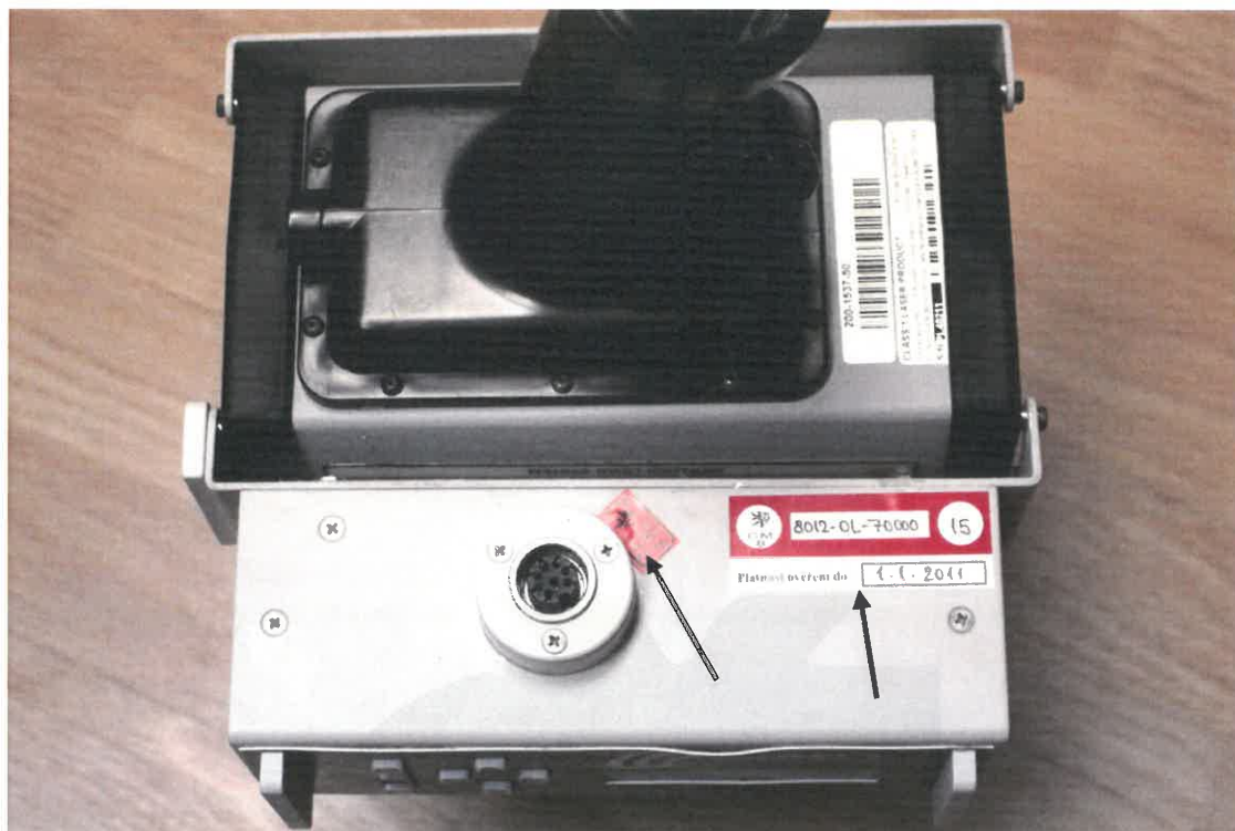
Obr. 4 Umístění nalepovací první úřední značky a ověřovacího štítku na řídicí, výpočetní a dokumentační jednotce. Úřední značkou se přelepí upevňovací šroubek vedle konektoru na spodní straně dokumentační jednotky.
