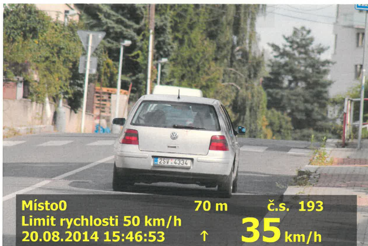
Obr. 3 Příklad snímku z dokumentačního zařízení při měření rychlosti na odjezdu
